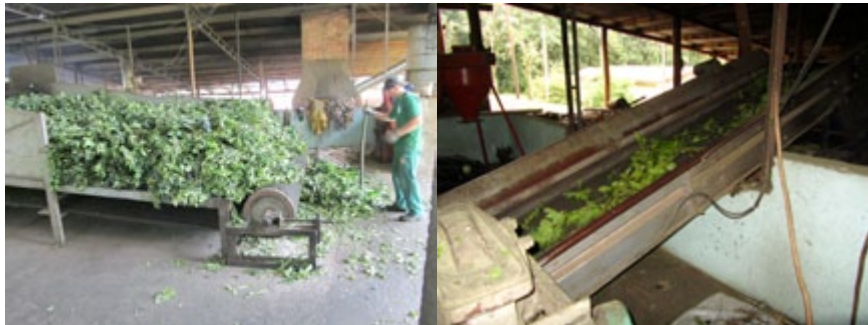
Figuras 12 e 13: Área de recepção da Erva-Mate e Esteiras que levam a Erva-Mate para a etapa de sapeco
