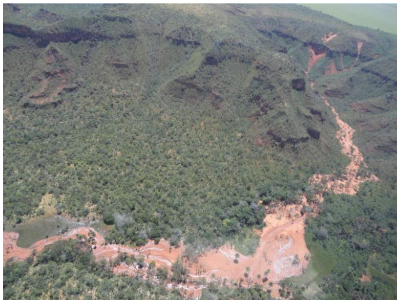
Figura 2.1.2.3-8. Movimento de massa rotacional seguido de assoreamento do Rio São Vicente, São Domingos – GO. Fonte: Competer (2013) 17
