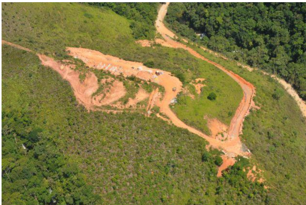
Figura 2.1-3. Deflagração de processos erosivos em múltiplos pontos do empreendimento “Pedrão do Sem Fim”. Foto: Clayton F. Lino 31/01/2014
